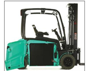
Châssis d'échange latéral de batterie
