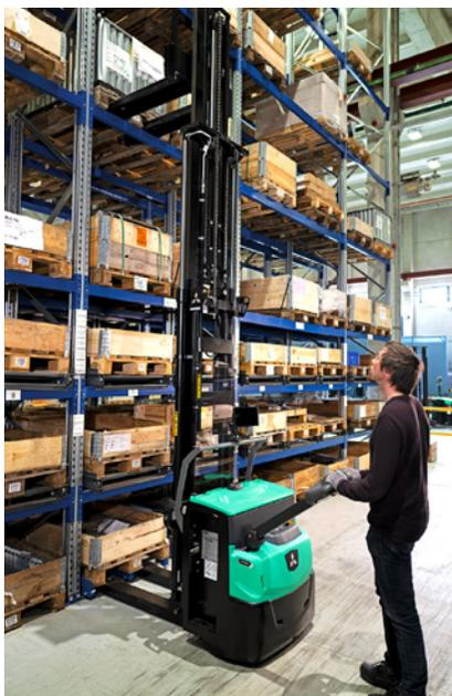
Grâce à son châssis de protection clos et des composants étanches (classés IP54) qui ne craignent pas les saletés, la poussière, les débris et l'eau, l'AXiA ES travaille aussi bien à l'intérieur qu'à l'extérieur et ne nécessite qu'un minimum d'entretien.
