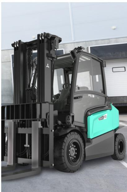
Un cariste confortablement installé sera plus productif. Le compartiment cariste de l'EDiA XL est monté sur des supports en caoutchouc qui réduisent les micro-vibrations, et le niveau sonore global à l'intérieur de la cabine ne dépasse pas 65 dB. L'EDiA XL comprend également des options de climatisation et de chauffage grâce auxquelles le conducteur peut régler la température à sa convenance et évoluer dans un environnement convivial qui lui permet de se concentrer essentiellement sur sa tâche.
