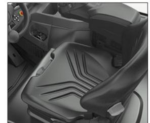
Siège vinyle Grammer à suspension
