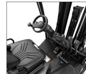
Levier de commande hydraulique manuel
