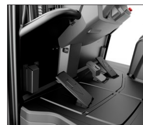
Système de pédale double - avant et arrière.
