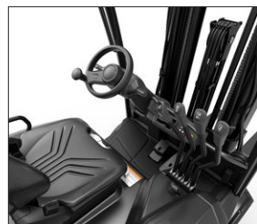
Levier de commande hydraulique manuel.
